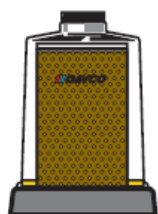
Новый фильтрующий элемент. Низкий уровень положения топлива.
