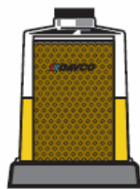
Фильтрующий элемент после некоторой эксплуатации. Средний уровень положения топлива.
