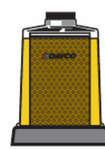
Фильтрующий элемент требующий замены. Уровень топлива достиг и постоянно находится у верхнего края фильтрующего элемента.
