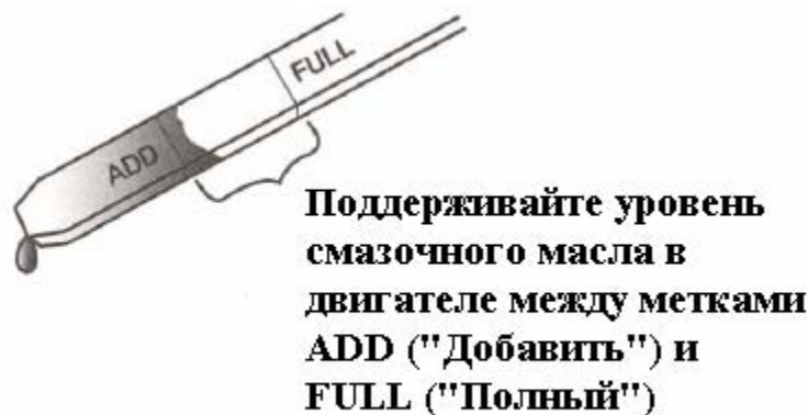
Рис.16. Проверка уровня смазочного масла щупом старой конструкции
