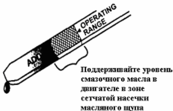
Рис.15. Проверка уровня смазочного масла щупом новой конструкции .
